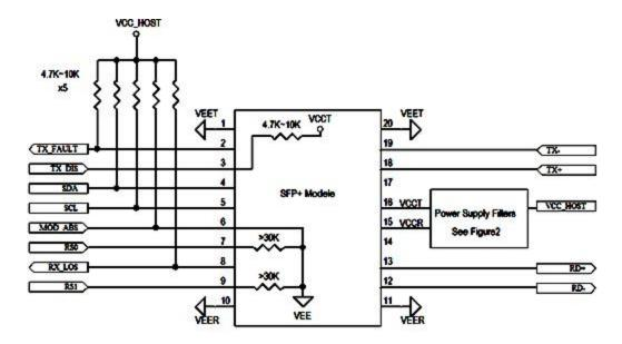
Figure 3. Host-Module Interface
